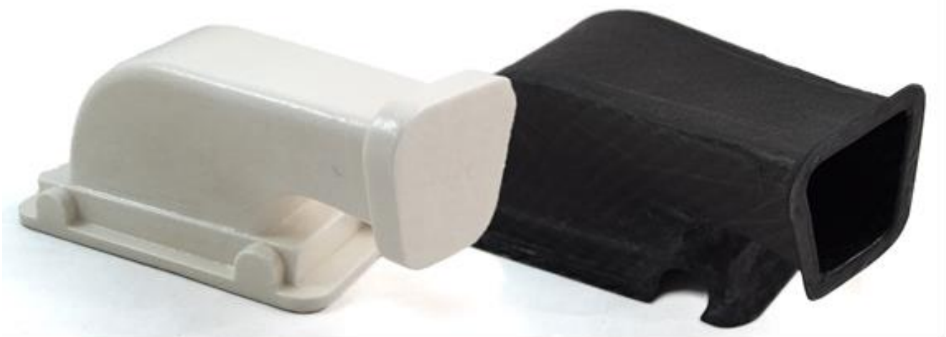
Abbildung 2: Additiv gefertigter Kern für die Fertigung des Getriebekühlkanals (links); mittels additiv gefertigtem Kern produzierter Getriebekühlkanal aus CFK (rechts)
