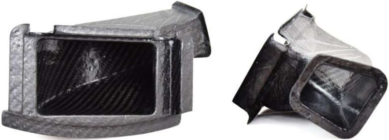
Abbildung 3: Getriebekühlkanal, welcher mittels Handlaminieren und Autoklav-Verfahren mit Hilfe eines additiv gefertigten Kerns produziert wurde
