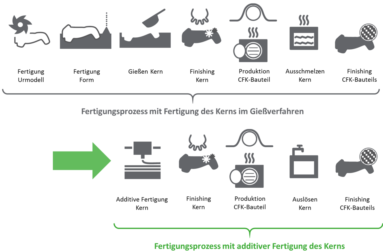
Abbildung 1: Fertigungsprozess der CFK-Bauteilproduktion mit Fertigung des Kerns im Gießverfahren (oben); Fertigungsprozess der CFK-Bauteilproduktion mit additiver Fertigung des Kerns (unten)
