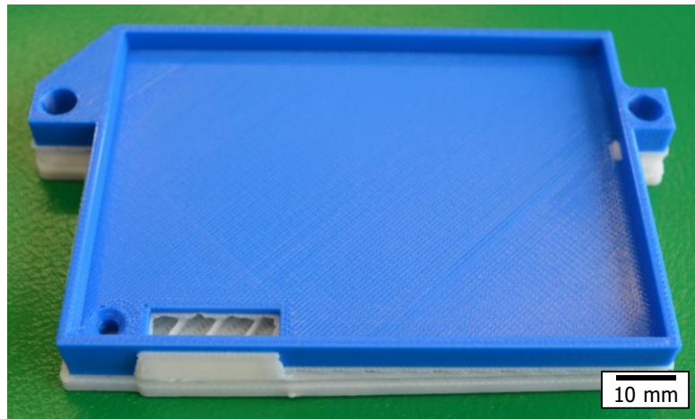
Abbildung 3: Durch FLM gefertigte Displayhalterung mit der benötigten Stützstruktur
